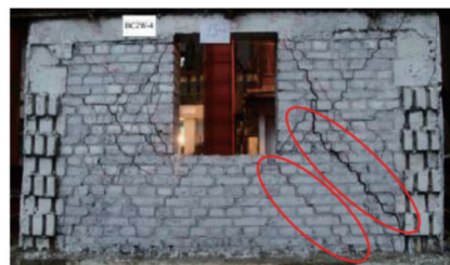
图5 文献[9]中砌体墙BC2W-4开裂情况
