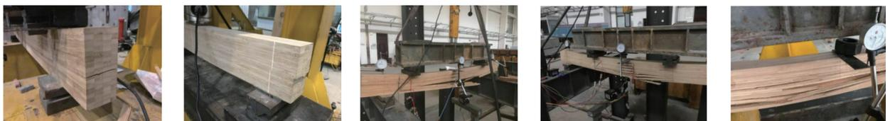
(a) CL1左端层间开裂 (b) CL2端部层间开裂 (c) CL3跨中断裂破坏 (d) CL4跨中断裂破坏 (e) CL5跨中断裂破坏
