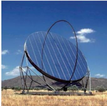
图4 张力金属反射膜定日镜<sup>[19]</sup>
