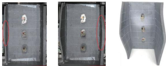
(a) 翼缘微小变形 (b) 被加劲板变形 (c) 最终破坏形态
