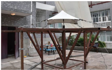
图 8 四面拼接的伞形膜面
