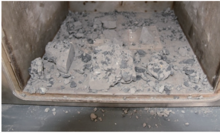
图 5 微波加热下试件炸裂
