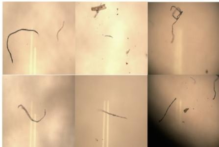
图 11 农业土壤消解后的微塑料电子显微镜图
