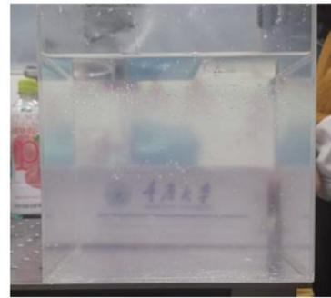
图9 配置完成的透明土试样
