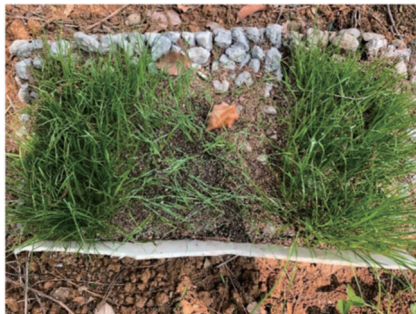
图 11 黑麦草与高羊茅在降碱处理后的大孔隙生态混凝土试件中 28 d 的生长状况
