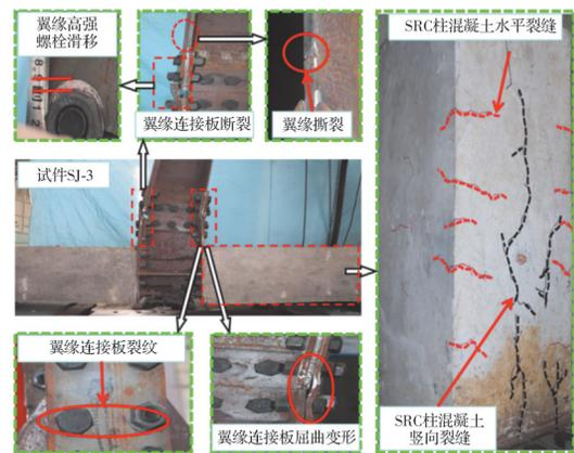
图 8 试件 SJ-3 整体及局部破坏
