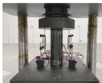
图2 应变片布置及试验装置
