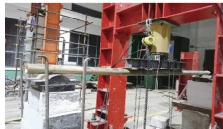
图4 毛竹杆受弯性能加载装置图
