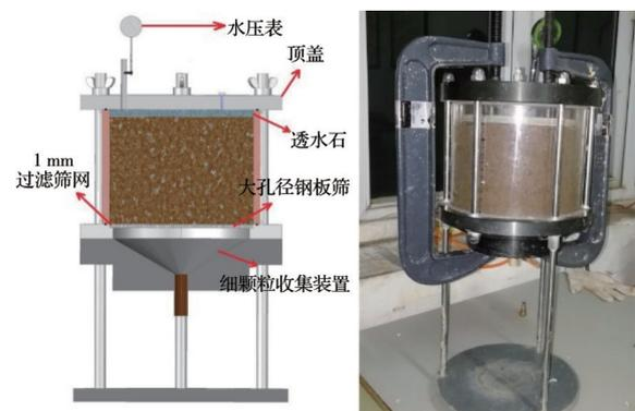
图1 渗流潜蚀试验仪器模型及实物图
