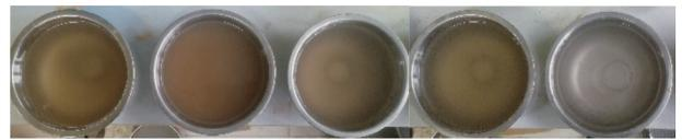
图 3 不同潜蚀阶段收集的含细颗粒浑水照片 ( $e_0=0.85, i=20$ )
