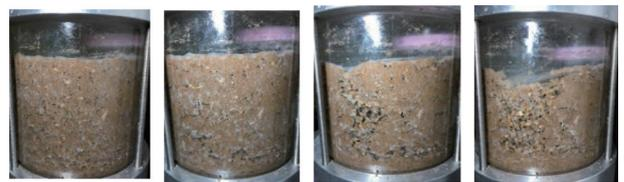
图 4 不同潜蚀阶段土样细颗粒流失及变形 ( $e_0=0.85, i=20$ )
