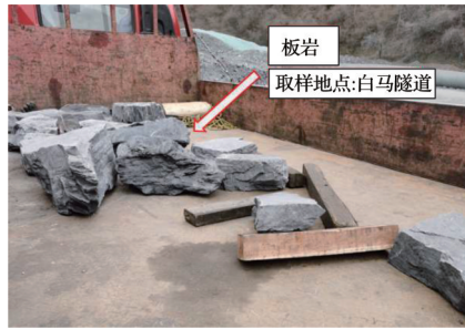
(a) 板岩现场取样(白马隧道)
