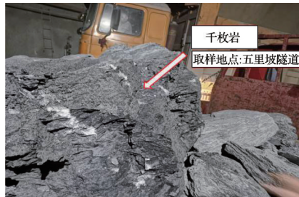
(b) 千枚岩现场取样(五里坡隧道)
