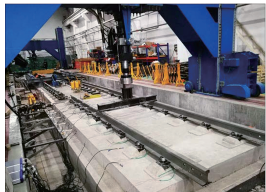
图5 双块式轨道列车荷载试验 [79]
