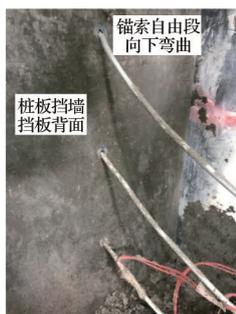
图 15 破坏后的锚索自由段
