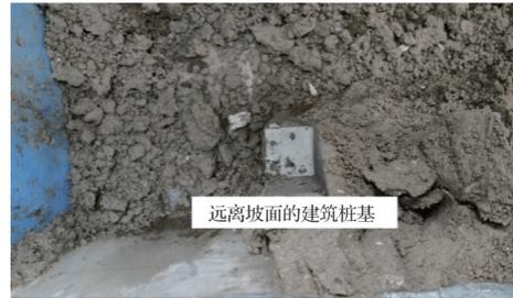
图 17 折断后的建筑桩基
