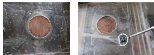
(a) 环刀侧壁土体流失 (b) 土体开始冲刷起动
