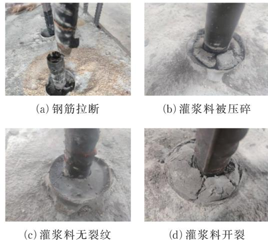
图4 试件的破坏形式
