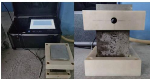
图1 暂态电阻测试仪
