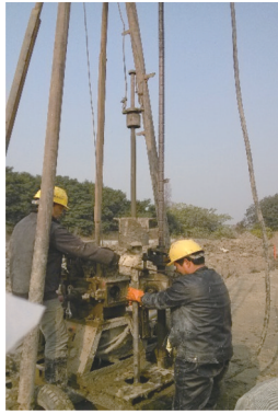
图 4 标准贯入试验现场图
