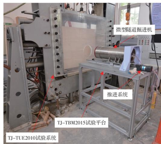
图 1 多功能微型隧道掘进机试验系统
