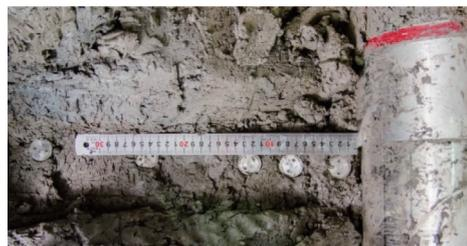
图 12 土压力盒布置实物图 (L1-L5)
