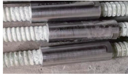
图 6 钉头螺母滑脱破坏
