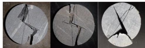
(e) 单裂隙试件60°加载
