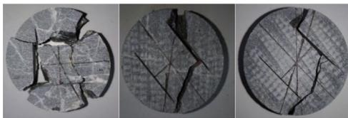
(e) 平行双裂隙试件60°加载
