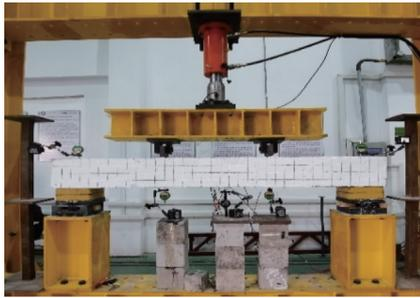
图 3 试验梁加载图
