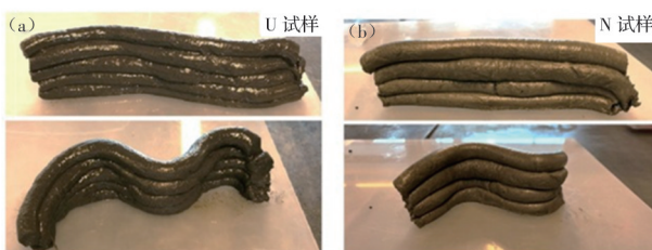
图 19 尿液作为胶结剂的月壤 3D 打印构件 [107]
