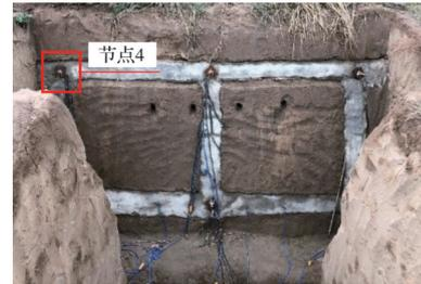
图 6 框锚边坡现场试验
