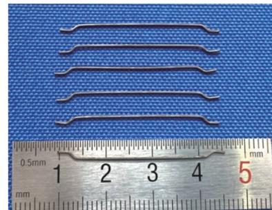
图1 结构型钢纤维
