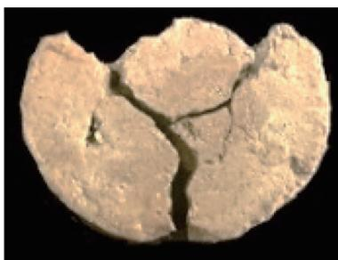
图 11 石灰固化铅试样浸水 21 d 后土样破碎
