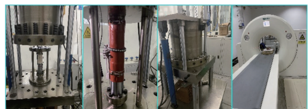
(a) 试样 (b) 热缩管 (c) 三轴压力室 (d) CT扫描仪
