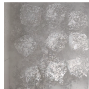
图 7 碱矿渣混凝土高温爆裂
