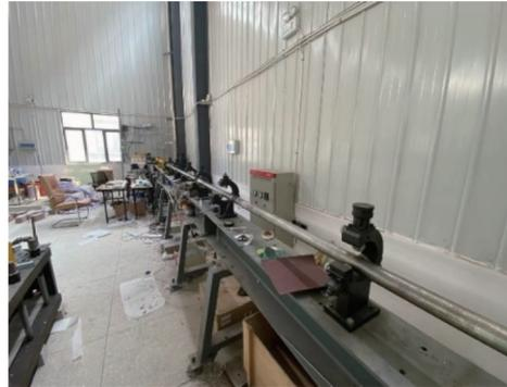
图2 SHPB测试装置
