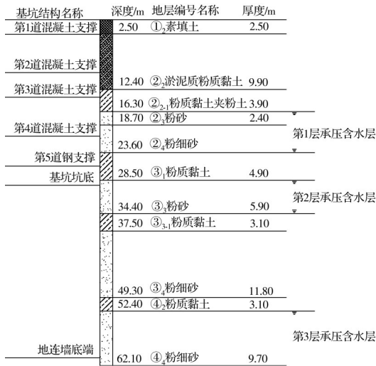
图 4 江北深基坑工作井地层剖面
