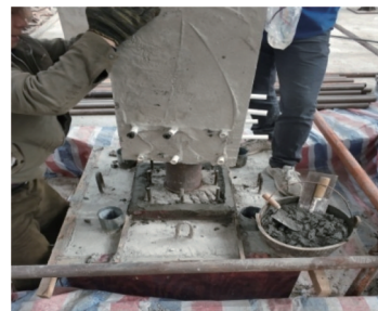
图6 榫卯-灌浆套筒混合连接
