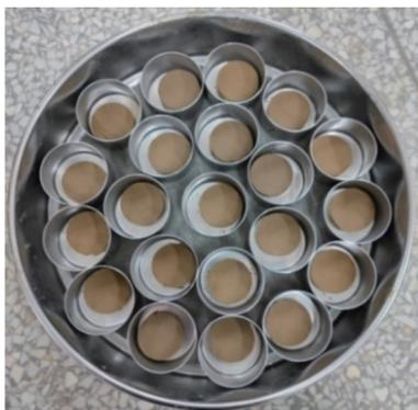
图 1 非饱和黄土水蒸气吸附试样
