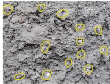
图 15 骨料分散在固化淤泥土中
