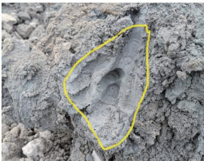
图 13 固化淤泥土中的软弱部分
