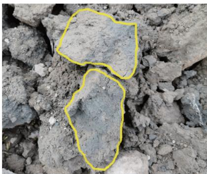
图 14 固化淤泥土中的硬化部分
