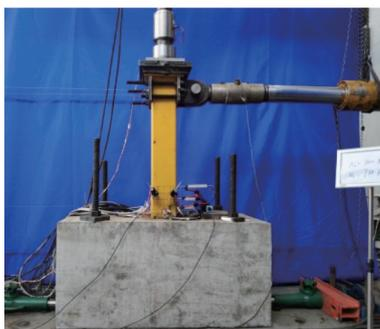
(b) Z 类型拼接柱试验现场加载图
