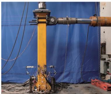
(c) P 类型拼接柱试验现场加载图
