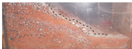
(b) 降雨3 h室内模型破坏结果
