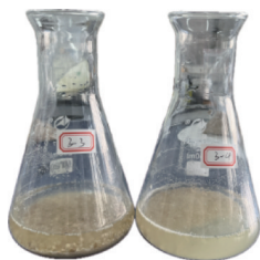
图5 静置在过量盐酸中的破坏试样
