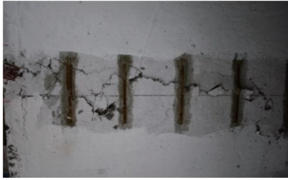
图 11 RC 顶板破坏形态图
