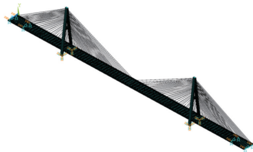
图3 斜拉桥有限元模型
