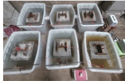
(a) 室内加速锈蚀试验
