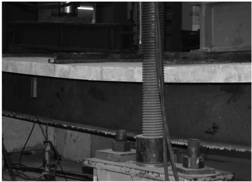
(b)钢次梁受弯破坏(II型)
