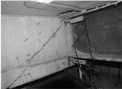
(a)混凝土梁剪切破坏(I型)
