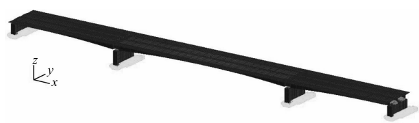
图 4 张家港河大桥主桥的有限元模型
