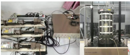
图 1 GDS 空心扭剪试验仪器图
