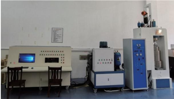
图 1 DZSZ-150型多场耦合岩石三轴压力试验机
