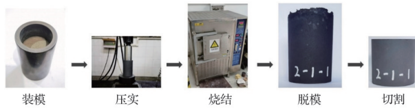
图8 烧结试件制备流程图
