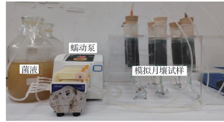
图4 微生物注浆示意图
