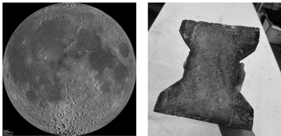
图 11 月表照片(亚利桑那州立大学拍摄)(左) [37] 与笔者制备的微生物模拟月壤砖(右)
