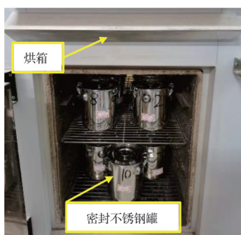
图 1 MX-80 膨润土的高温强碱作用模拟过程
