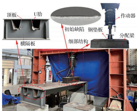
图3 钢桥面板足尺模型
