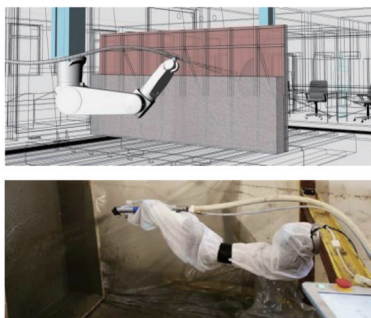
(a) 混凝土自动喷涂机器人 [54]
