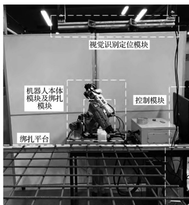
(b) 钢筋自动绑扎机器人 [55]
