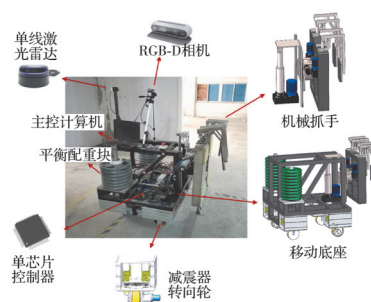
(c) 墙板自动安装机器人 [56]
